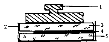
图 9-3 流动度测定装置示意图 1—砝码(200g) 2—金属盘 3,5—圆玻璃片( \phi 70\text{mm} , 50g) 4—油墨试样
